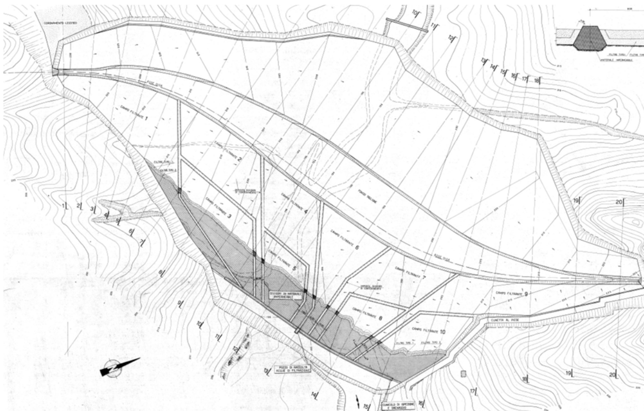
Figura 3.2: Diga di Gibbesi – Planimetria della diga e posizione dei cunicoli d'ispezione dei drenaggi, con relativo torrino di discenderia (Progetto di fattibilità del 1972)
